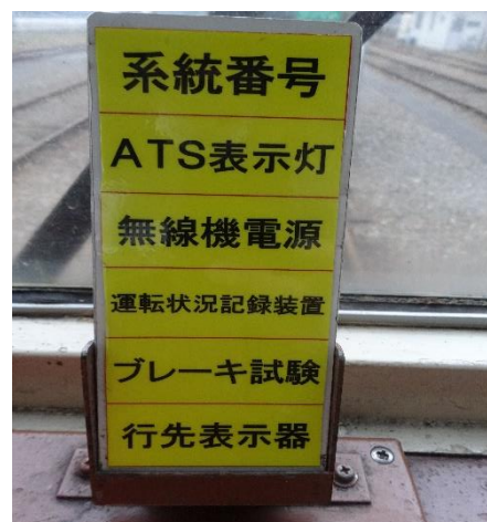
黄色で目立つ確認板を設置
